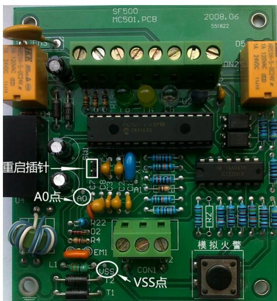
图 2 微电脑处理器内部测量点
